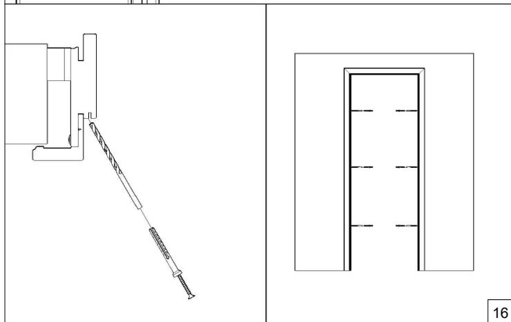
Вариант крепления дверного короба в проем (через паз для уплотнителя)
