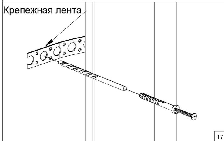
Вариант крепления дверного короба в проем (через крепежную ленту)
