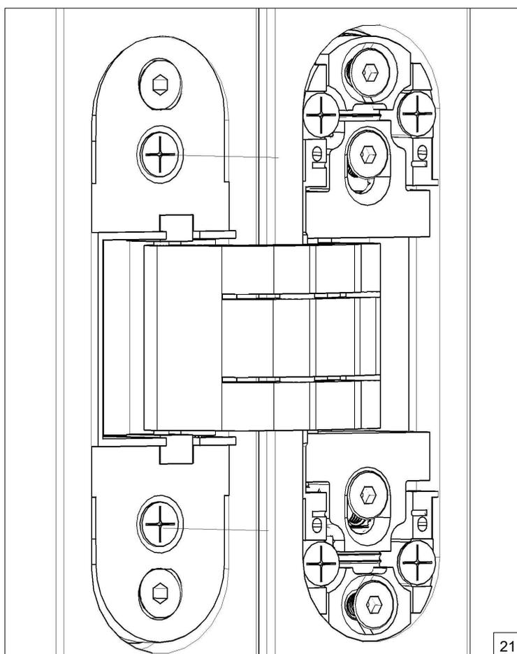
Регулировка бокового зазора (21-22)
