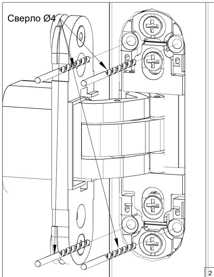
2 Подготовьте отверстия для крепления закладных пластин
