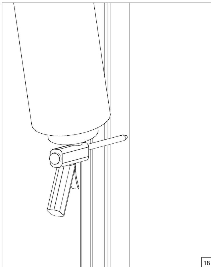
Запенивание монтажного зазора
