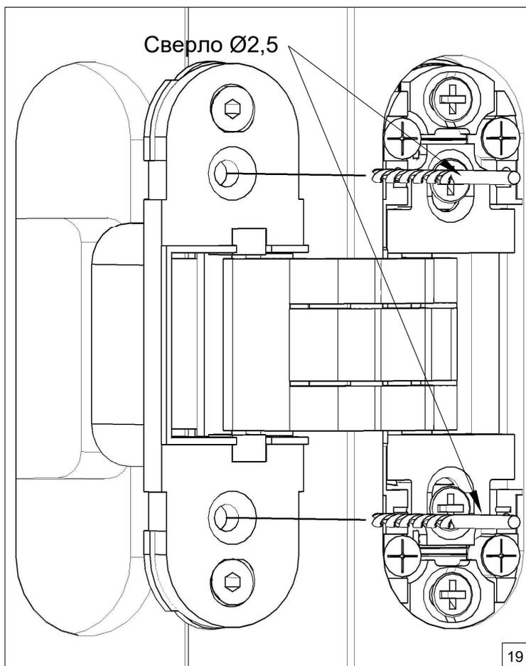
Подготовка отверстий для крепления петли в полотно
