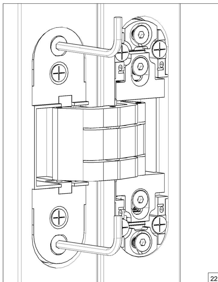
Регулировка бокового зазора(21-22)
