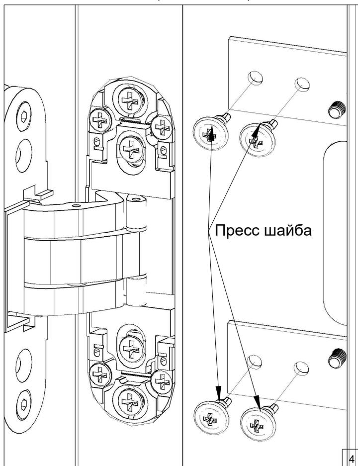
4 Зафиксируйте закладные пластины
